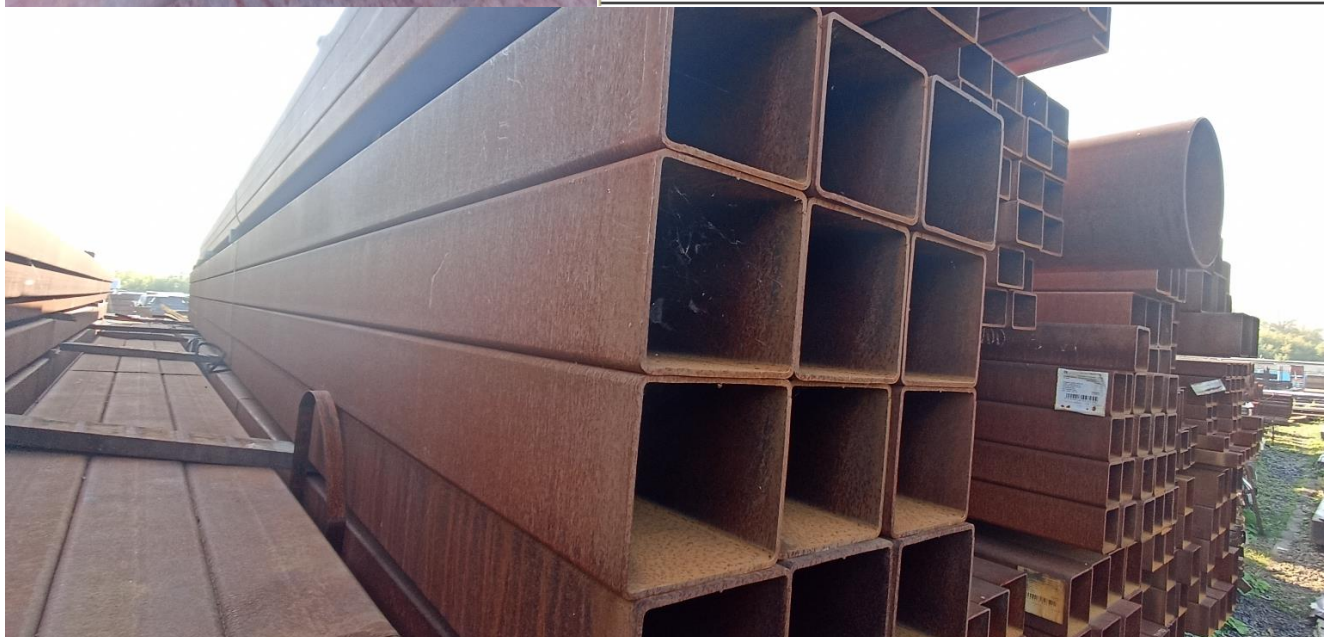
Труба профильная 180*180*6*12000-МД-09Г2С-15 ГОСТ 30245-2003,ГОСТ 19281-2014 (ТЭМПО) – 7.691т
